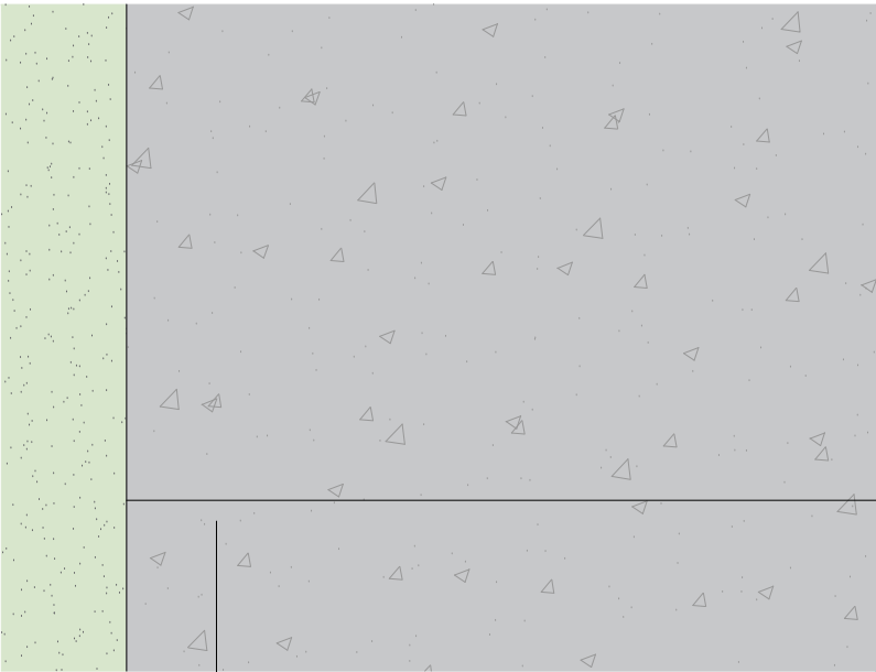
Juntas aserradas con profundidad \frac{1}{4} del espesor de hormigón, max. 6mm de ancho.
